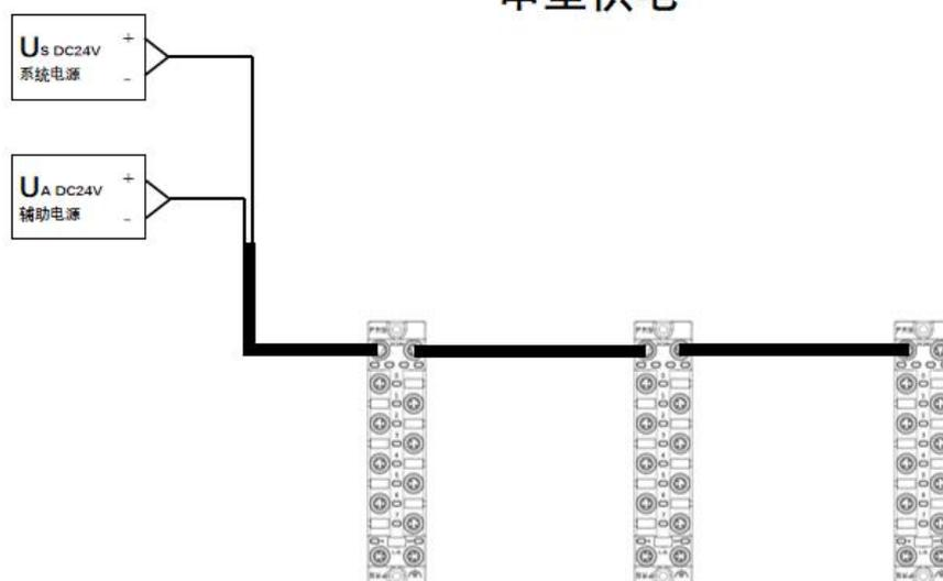
在串行供电接线模式下，若后面模块需要接线到前面模块，那么就要累加电流不超过 4A。
