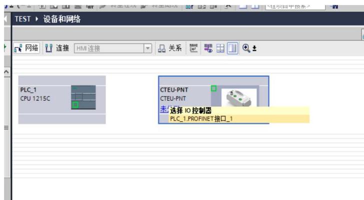
双击 CTEU-PNT 进入设备概览，依据线圈个数在插槽 1 配置输出数据大小;先右键删除插槽 1 配置，后拖动参数到插槽 1。
