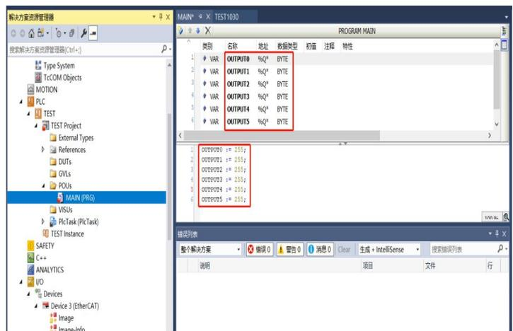
右键 PCL 程序项目（TEST Project）-生成
