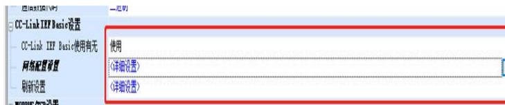
网络配置设置-双击详细设置-连接设备自动检测
