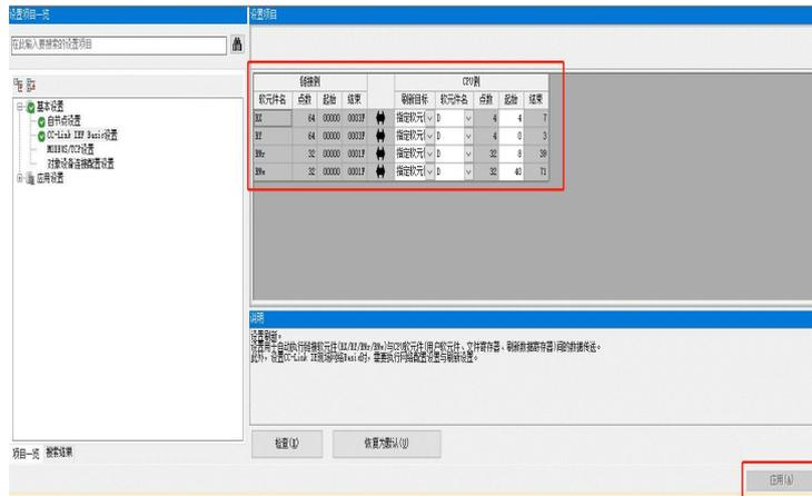
软元件/缓冲存储器批量监视-将 D0,D1,D2（对应 RY 输出数据）全部位置 1，可以看到 48 路线圈全部输出。
