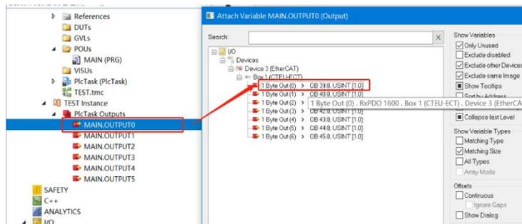
如下图标显示已经关联成功，下载程序后，48 路线圈输出全为 1
