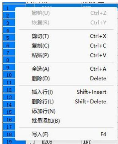
点击进入后将软件元类型选为 D 并且将起始地址和终止地址填写为之前在 Modbus TCP 配置页面添加的映射地址点击确定：
