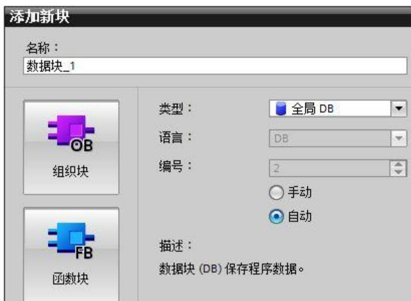
第二步，双击打开 DB2，定义变量名称为 “aa”，数据类型为 “TCON\_IP\_v4” （可以将 TCON\_IP\_v4 拷贝到该对话框中），然后点击 “回车” 按键。该数据类型结构创建完毕：
