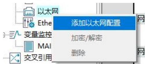
进入菜单后将模块的 IP 地址及端口号填入其中后点击确定：
