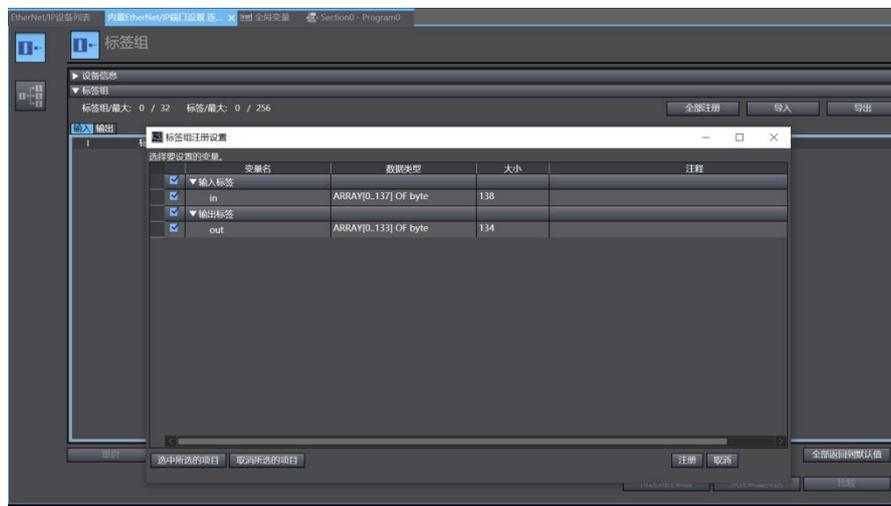
(3) 在内置 ETHERNET/IP 端口设置窗口中--选择左侧第二个图标（连接）---点击“+”，目标设备选择之前配置好的模块，IO 类型选择 EXCLUSIVE Owner，选择对应输入输出，目标变量必须填 101,100;再选择对应的起始变量，完成后在线。选择“传送到控制器”，组态完成！
