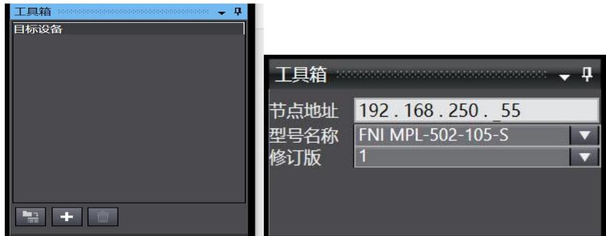
3、配置模块: 右键模块--选择“编辑”---参数里根据实际需要进行配置对应数值完成后点击确定
