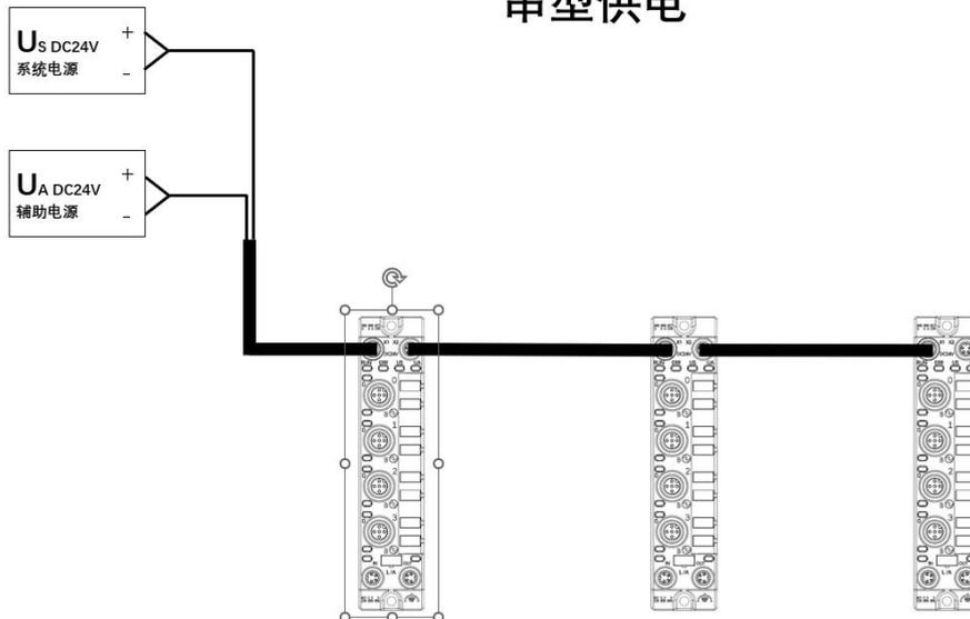
在串行供电接线模式下，若后面模块需要接线到前面模块，那么就要累加电流不超过 4A。
